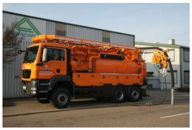
Hochdruck Spül- und Saugfahrzeug mit Wasseraufbereitung
